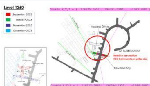
Niveau 1290m traçage d'un accès sous niveau à 1260m
