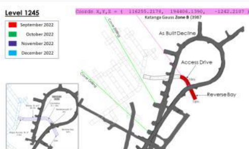
Niveau 1245m traçage d'un accès sous niveau à 1220m
