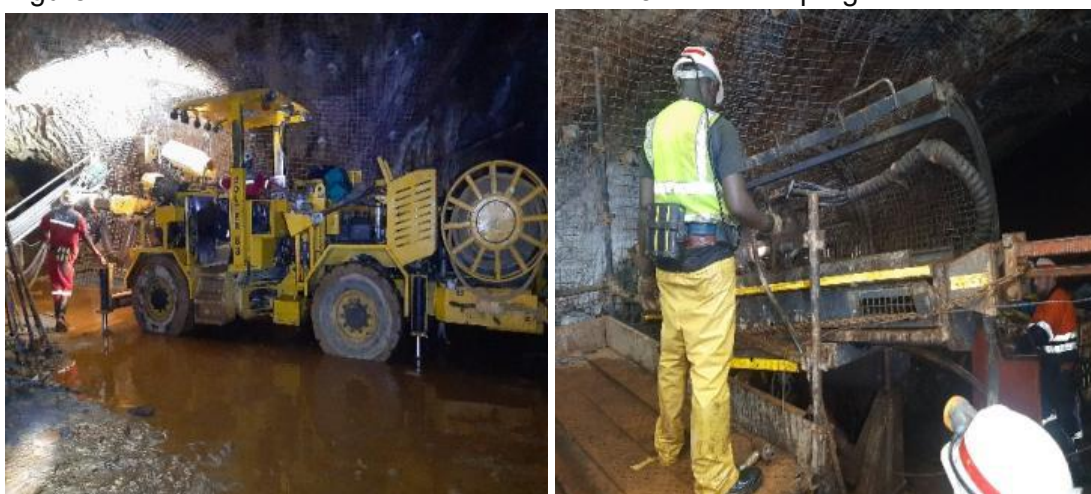
Figure 41 : Travaux de soutènement au niveau 1327 et de la progression de l'incliné.
